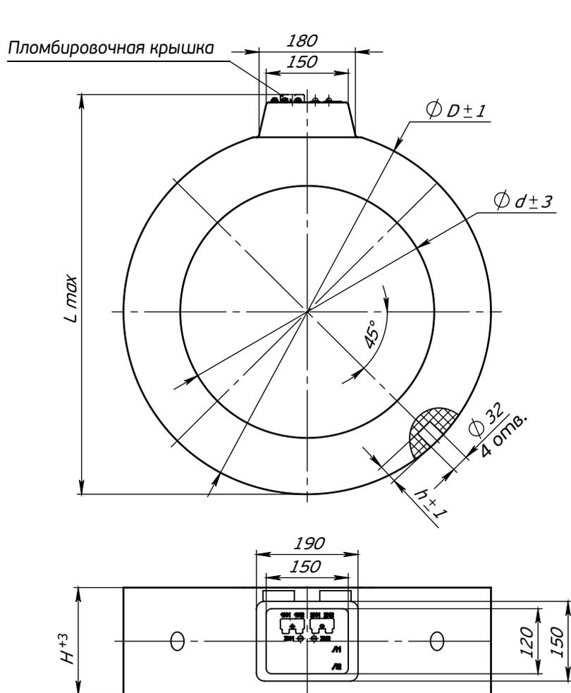
Рис. 1 - Общий вид трансформаторов тока ТВ-СВЭЛ-20-V-2(3,4,5)
