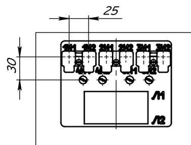
Рис. 3 - Панель контактов трансформаторов тока ТВ-СВЭЛ-20-V-4(5)
