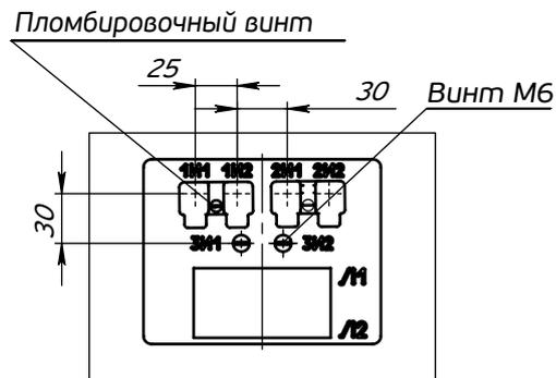
Рис. 2 - Панель контактов трансформаторов тока ТВ-СВЭЛ-20-V-2(3)
